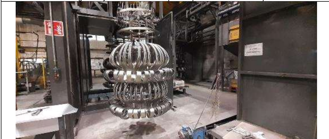
Árbol de brazos tras salir de la granalladora, ubicada detrás del árbol
